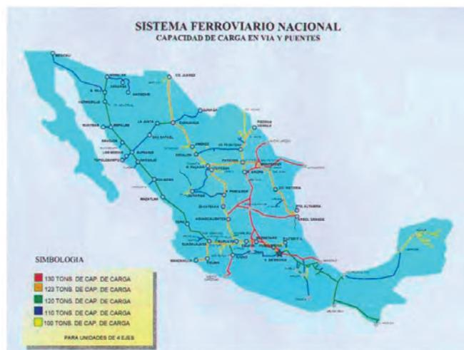
FIGURA 5. Capacidad de carga en vías y puentes del Sistema Ferroviario Nacional.
